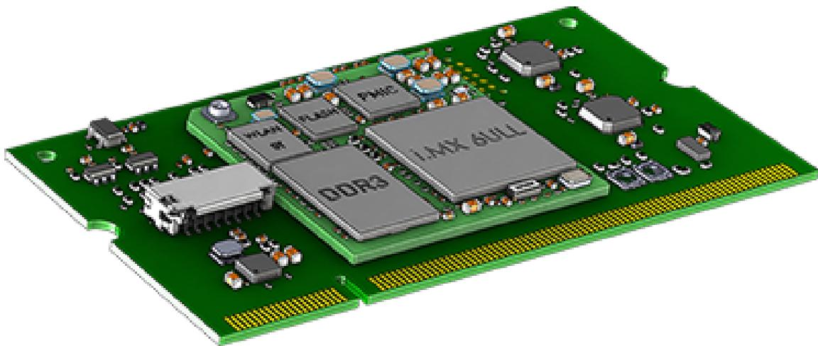
Das DHCOR i.MX6UL(L) ist ein kostengünstiges, 15 Jahre langzeitverfügbares SOM (System-on-Module) nach dem SODIMM-200 Standard. Der eigentliche Kern ist mit dem nur 29 x 29 x 3,2 mm kleinen, eingelöteten DHCOR i.MX6UL(L) Modul realisiert.
